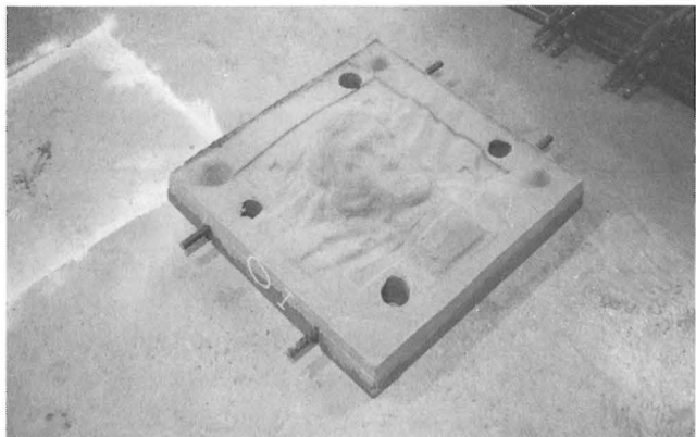
3. 中子型取。鋳型に粘土を4から6mmの厚さに張りつけ再び型を取る。鋳造後は裏面の形となる。4つの孔は注油の注ぎ口と発生するガスの蒸発を補助するためのもの。
