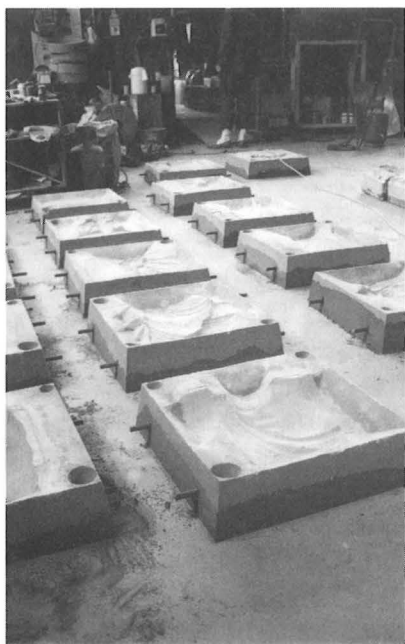
2. 鋳型取。珪砂によって表面部の雌型を成形。
