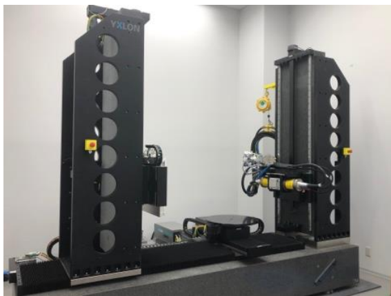
図 11 当館設置の X 線 CT 装置
